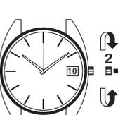
③リユースを回し日付が変わるまで針を進めます。午前の場合はそのままにします。なお、午後の場合は、時針が一度12時を超えるまで針を進めます。正しい時刻より4～5分針を進めます。つぎに、針を戻して、正しい時刻にします。
