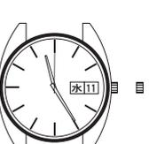
④時報と同時にリユースを押し込み1の位置に戻します。
