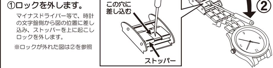
②位置を決めます。ストッパーの底の出っ張りをバンドのコマとコマの隙間に合わせます。
