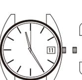
④時報と同時にリユースを押し込み1の位置に戻します。
