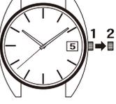
②リユースを回して正確な日の、前日の日付を表示させます。その後、リユースを3の位置まで引き出します。（秒針が止まります）秒針は12時の位置に止めます。
