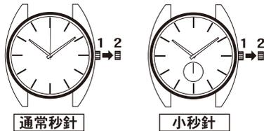
②リユースを回して針を合わせます。まず、正しい時刻より4～5分針を進め、つぎに針を戻して正しい時刻にします。
