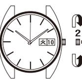
③リユースを回し日付が変わるまで針を進めます。午前の場合はそのままにします。なお、午後の場合は、時針が一度12時を超えるまで針を進めます。正しい時刻より4～5分針を進めます。つぎに、針を戻して、正しい時刻にします。
