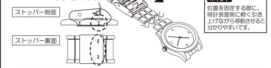
③ストッパーを固定します。マイナス精密ドライバー等を図の様に指定の穴に差し込みベルト末端に向けて倒すように固定します。素手でストッパーを押し込み固定することは、とても固く難しいので、図の様な精密ドライバーを使ってください。
