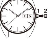
②リユースを回して正確な日の、前日の日付と曜日を表示させます。その後リユースを3の位置まで引き出します。（秒針が止まります）秒針は12時の位置に止めます。
