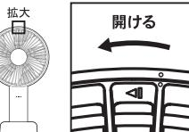
●ガードを折らないよう両手でしっかりと外側を押さえて、正面のガードを拡大図の矢印方向(反時計回り)に「カチッ」と音がするまで回転して取り外します。
