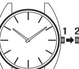
②リューズを回して針を合わせます。まず、正しい時刻より4~5分針を進め、つぎに針を戻して正しい時刻にします。
