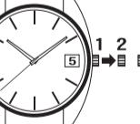
②リューズを回して正確な日の、前日の日付を表示させます。その後、リューズを3の位置まで引き出します。（秒針が止まります）秒針は12時の位置に止めます。
